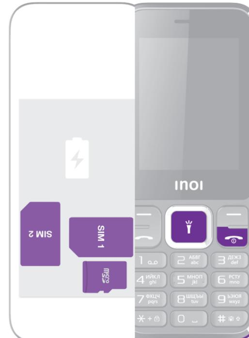
Снимите батарею и установите одну или две Mini SIM карты.
