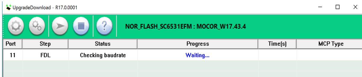
5. Подключите телефон в выключенном состоянии к ПК удерживая 1-2 секунды (левую функциональную клавишу или клавишу «0»), после данных действий прошивка должна запуститься автоматически, в строке состояния отобразится процесс загрузки прошивки:
