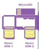
La bandeja SIM tiene opción híbrida. Para aumentar el espacio de almacenamiento, retire la tarjeta SIM2 e inserte una tarjeta MicroSD de hasta 128 GB en el espacio provisto en la bandeja SIM
