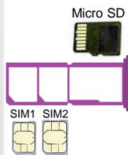
Öffnen Sie das SIM-Fach mit der SIM-Karten-Auswurf-PIN und legen Sie eine oder zwei Nano-SIM-Karten ein
